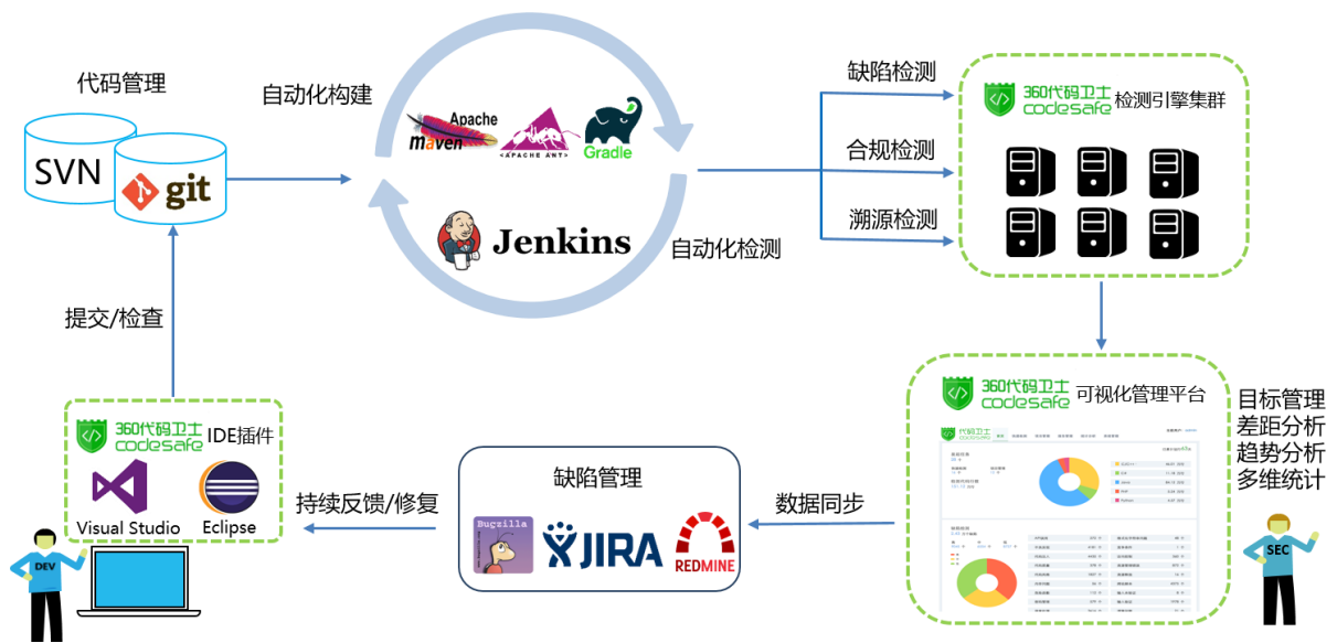
图 1 代码安全检测自动化示意图
